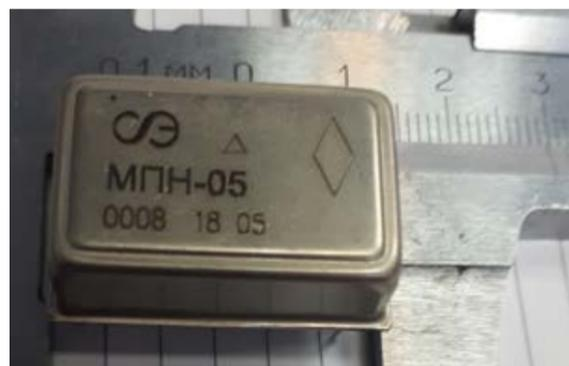
Фото 1. Микромодуль преобразователя напряжения газоразрядных счетчиков Гейгера-Мюллера
