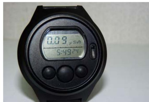
Фото 2. Дозиметр гамма-излучения наручный ДКГ-PM1603A/B
