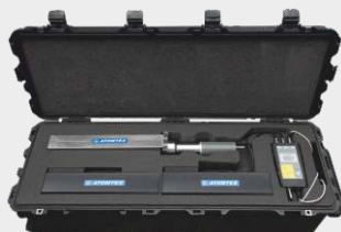
Измеритель высокочувствительный гамма- и нейтронного излучения: БДКГ-34 (1 шт.), БДКН-05 (2 шт.)
