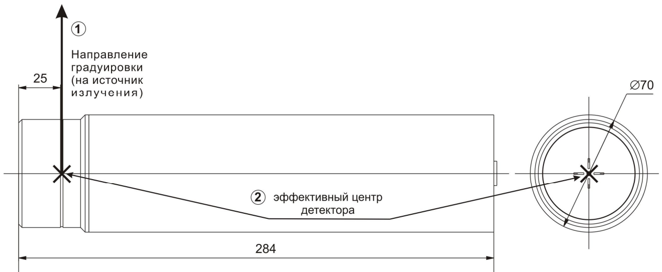
Рисунок 4.2 – Направление градуировки (1) и расположение геометрического (эффективного) центра (2) БДГ1
