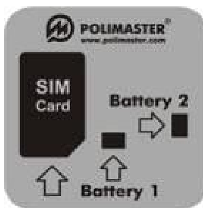
Рисунок 9.1 – Схема-инструкция подключения аккумуляторных батарей и SIM карты
