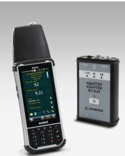
2) <u>Блок обработки информации БОИ4</u> (исполнение 2) представляет собой карманный персональный компьютер (КПК) со встроенным узлом детектирования, обеспечивающем измерение дозы и мощности дозы гамма-излучения в месте нахождения оператора.
