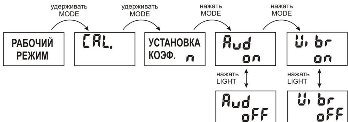
Сокращенная надпись "Aud" указывает на звуковую сигнализацию, надписи "oFF" ("on") – на выключенное (включенное) состояние звуковой сигнализации.
