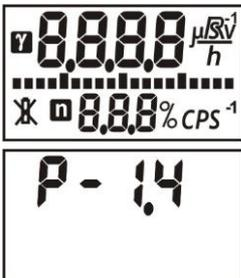
5.1.2.1 Для включения сигнализатора необходимо нажать кнопку MODE. Сразу после этого должна включиться подсветка ЖКИ и высветиться все сегменты ЖКИ одновременно, примерно на 1 с, должна включиться сигнализация (звуковая и/или вибрационная), сигнализатор должен перейти в *режим тестирования*. В *режиме тестирования* на ЖКИ, в течение нескольких секунд, индицируется номер программной версии (P-1.X<sup>1</sup>).
